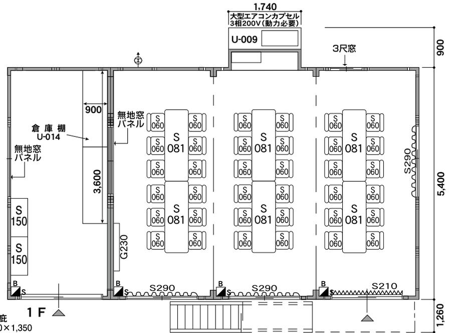
※連棟のブレーカー配線は分電盤等を使用し個別ブレーカー配線して下さい。
